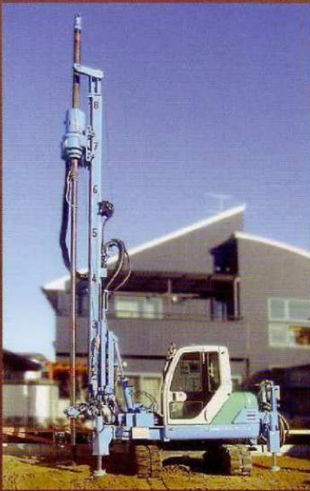
●YSパイルの施工機
